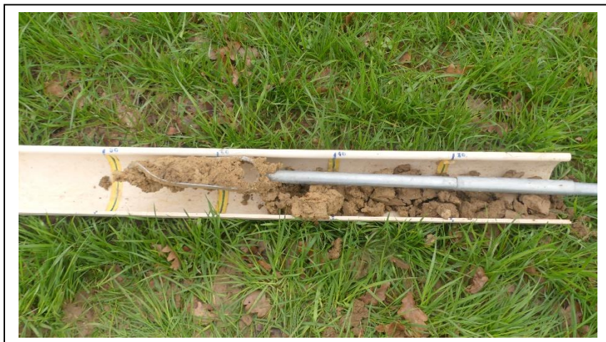
Sondage CLB 01 à la tarière indiquant une hydromorphie à partir de 35 cm sans horizon à gley au-delà de 80 cm
