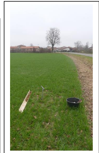
Sondage CLB 01 à la tarière indiquant une hydromorphie à partir de 35 cm sans horizon à gley au-delà de 80 cm
